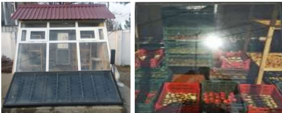
3-расм. ҚХМ ларни қуёш энергиясидан фойдаланиб қуритиш учун қуёш – иссиқлик насосли совутиш – қуритиш камерасининг умумий кўриниши.
