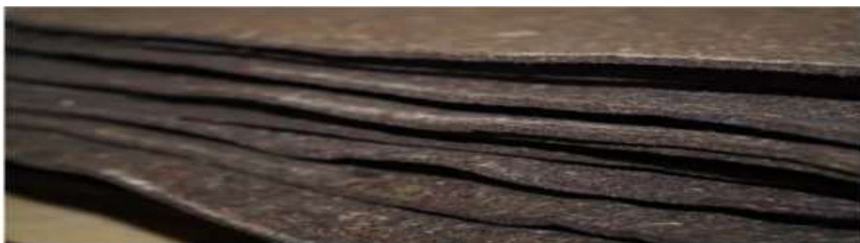
2-расм. Жун толаларидан олинган нотўқима матолар (автомобил саноатида ишлатиладиган нотўқима матолар).
