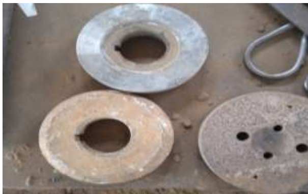
3-расм. Питаодпийатникнинг шикастланган кўриниши.
