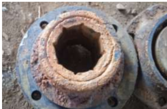
4-расм. Резина подшипникнинг шикастланган ҳолати.
