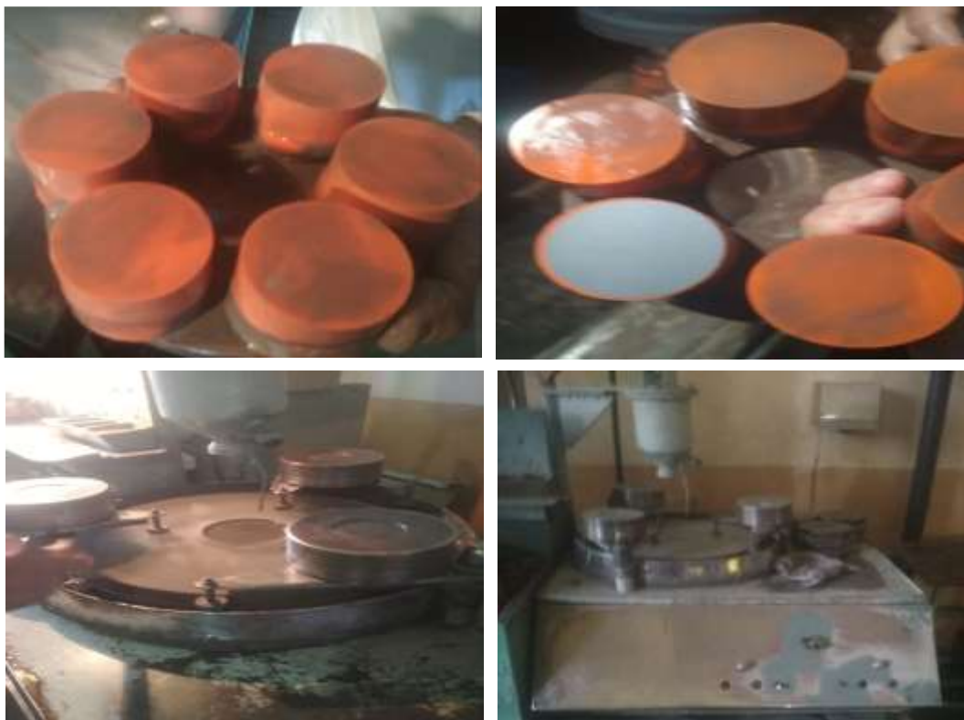
1-расм. М-5, М-7, М-10, М-14, М-10, М-20, М-28, М-40 микрокукунлар ёрдамида жилвирлаш ва сайқаллаш ишларини бажарувчи курилмада.
