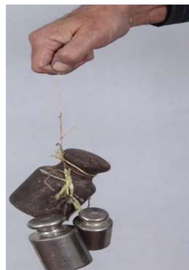
Рис.3. Процесс испытание прочностью мононитка из ребра кожуры.
