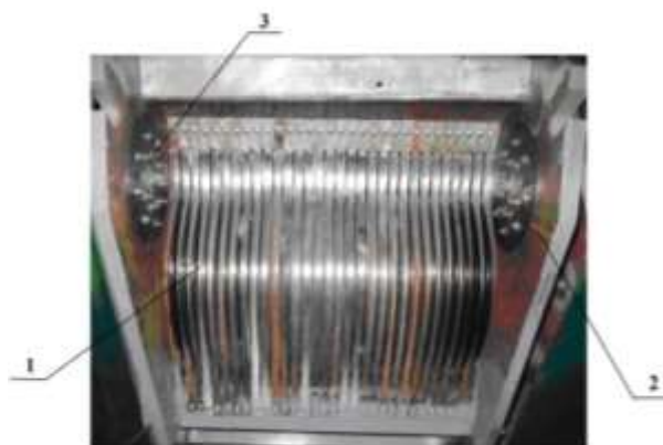
3-rasm. Jin ishchi kamerasing yon tomoniga o'rnatilgan qoziqchalarning sxemasi va tashqi ko'rinishi. (patent FAP 00990). 1-ishchi kamera, 2-ishchi kamerani yon tomoni, 3-qoziqchalar
