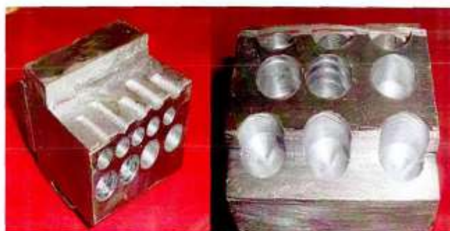
Рис. 2б. Образцы, подготовленные для проведения замеров шероховатости.
