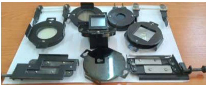
1-расм. Ёруғлик кутблантиргичининг деталларини ажратилган холатдаги кўриниши.
