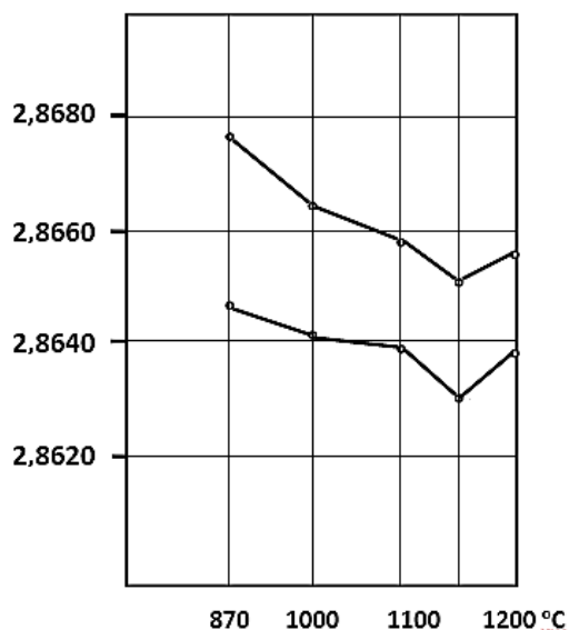
Рис 2.Изменение периода решетки стали У8А в зависимости от температуры предварительной закалки и промежуточного отпуска.
