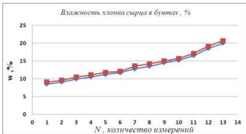
Рис.3. Зависимость показаний цифрового измерителя влажности хлопка – сырья и влагомера Wile Cotton. (желтая - показание цифрового измерителя влажности хлопка – сырья, синяя - прибора Wile Cotton).
