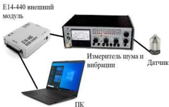
Рис. 1 а. Схема установки для измерения ВА сигнала.
