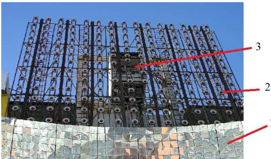
3-расм. КҚПнинг концентратор тепасига қурилган авторефлексия маркаси. 1- КҚП концентратори, 2-марка, 3-юстировкачилар хонаси.
