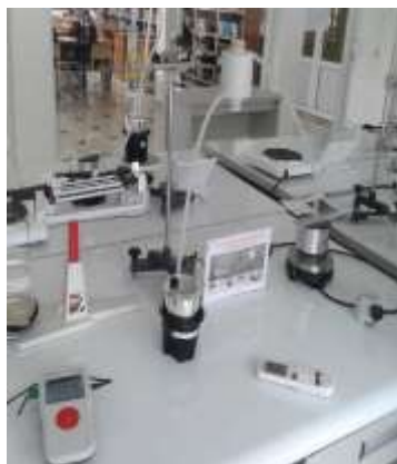
Рис.1. Принципиальная схема оборудования LD Physics (а) и общий вид (б). 1 – обогреватель; 2 – штатив; 3 – парогенератор; 4 – силиконовый шланг; 5 – стакан; 6 – сосуд Дьюара; 7 – весы (610 гр).
