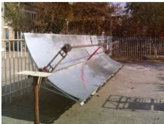
Рис. 1. Энергетический модуль параболоцилиндрического коллектора.
