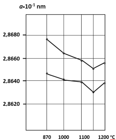
температуры предварительной закалки °С Рис. 3. Изменение периода кристаллической решетки в зависимости от температуры предварительной закалки °С.
