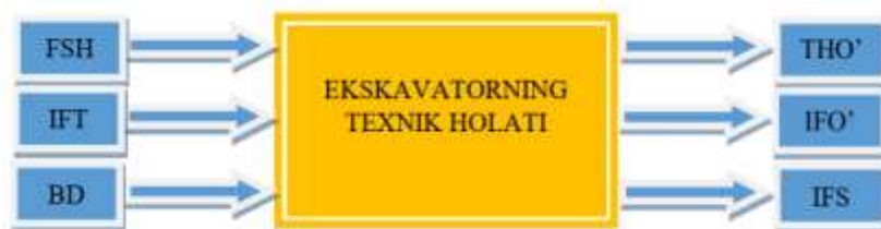
2-rasm. Karyer ekskavatorlarining texnik holatini belgilovchi omillarning asosiy guruhlari: FSH – foydalanish sharoitlari; IF- ishlash faoliyati tartibi; BD – boshqaruv darajasi /kasbiy tayyorgarlik, malaka/ ekskavator mashinisti; THO' – texnik holat o'lchamlari; IFO' – ishlash faoliyati o'lchamlari; IFS – ishlash faoliyati samaradorligi.
