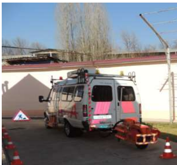
Рис. 2. Динамометрический прицеп типа ПКРС-2У в составе дорожной лаборатории.
