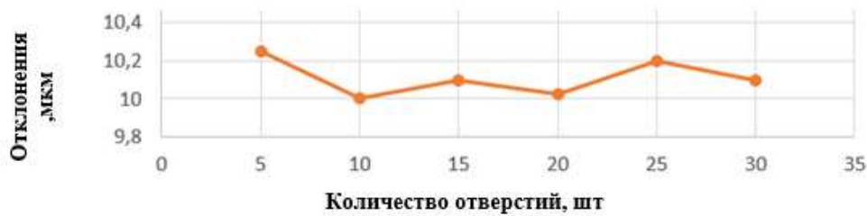
Рис. 4. Отклонения диаметров отверстий от диаметра сверла.
