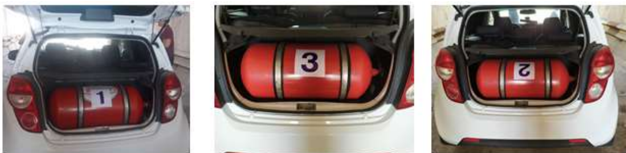
1-расм. Турли метан миқдорига эга бўлган биометан тўлдирилган газ баллонлар.
