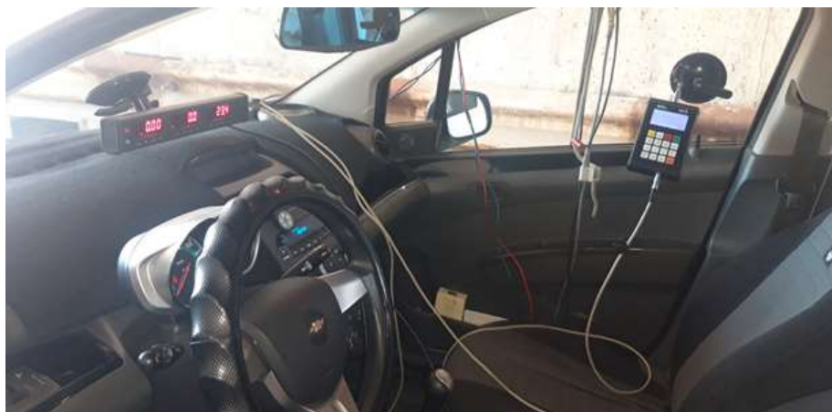
2-расм. Синов лаборатория жихозларини автомобилга ўрнатилган ҳолатдаги кўриниши.
