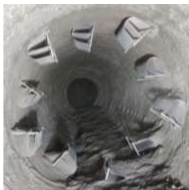
1-расм. Барабаннынг материал ёмғирини сочиш даражасини аниқлаш фоторасм намунаси.
