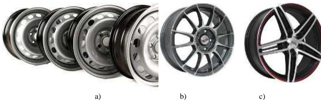
1-rasm. Engil avtomobil g'ildiraklarining asosiy turlari. a) shtamplab tayyorlangan po'lat g'ildiraklar; b) quyma g'ildiraklar; c) xajmiy shtamplab tayyorlangan g'ildiraklar.
