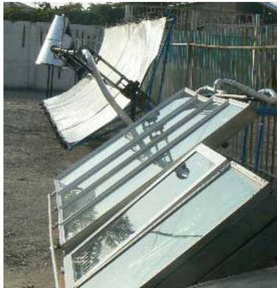
Рис. 2. Общий вид экспериментальной комбинированной установки с плоским и параболоцилиндрическим коллектором для получения технологической горячей воды.
