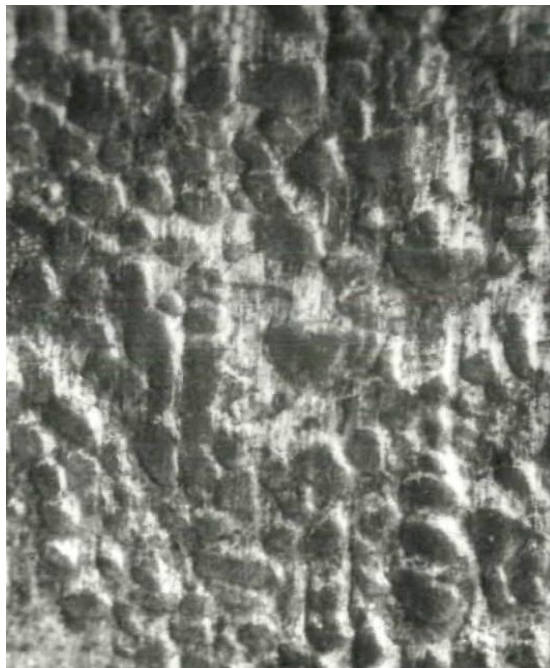
3-расм. Абразив ейилишга синовдан ўтказилган намунанинг қаттиқ қотишмалари бўртиб қолган юзаси.
