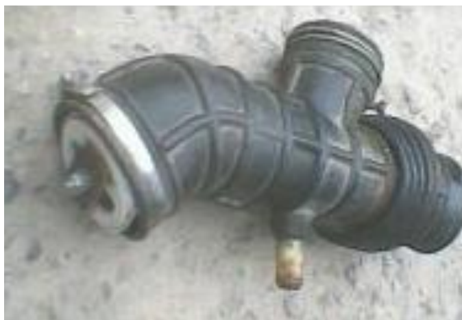
2-расм. «Нексия» автомобилининг ҳаво шлангига ўрнатилган озонатор
