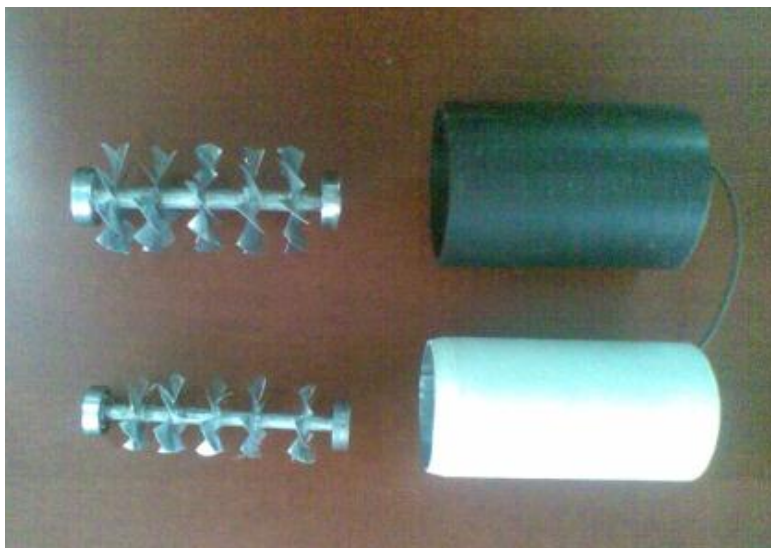
3-расм. Озонатор ички юзаси манфий ўқда жойлашган парракчалар.
