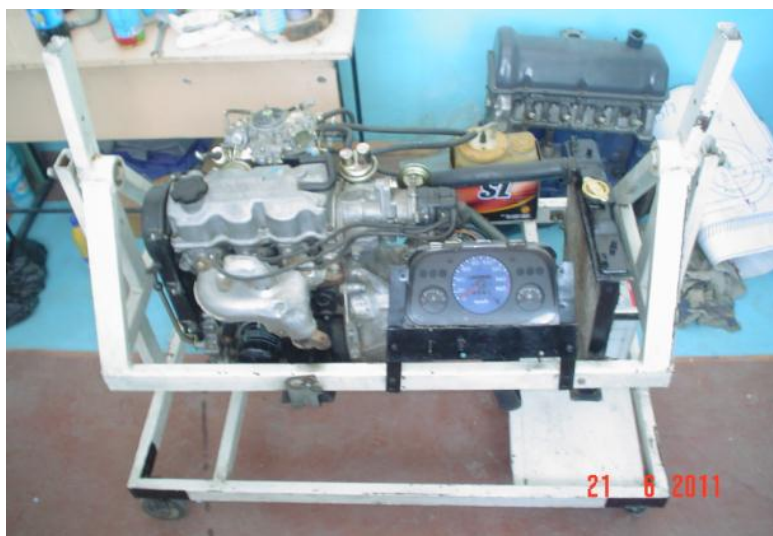
4-расм. “Тико” автомобили двигатели ўрнатилган стенд.
