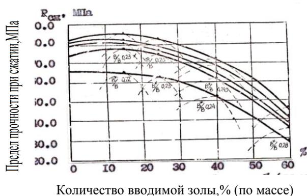
Рис. 3. Зависимость предела прочности при сжатии цементно-золяного камня от количества вводимой золы при различном времени помола. Номера кривых соответствуют времени помола. Соответственно: 1-30'; 2-45'; 3-60'; 4-90'; 5-120'.
