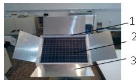
Рис.2. ФТП с концентратором (фронтальный вид): 1-Корпус ФЭБ, 2-ФЭБ, 3- концентраторы.
