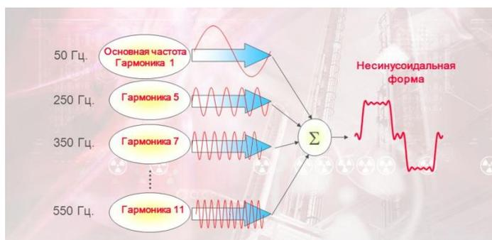
Рис.1. Гармонические искажения и несинусоидальность
