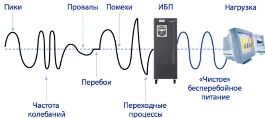
Рис.3. Схема пояснения защиты МИБП от неполадок в сети.
