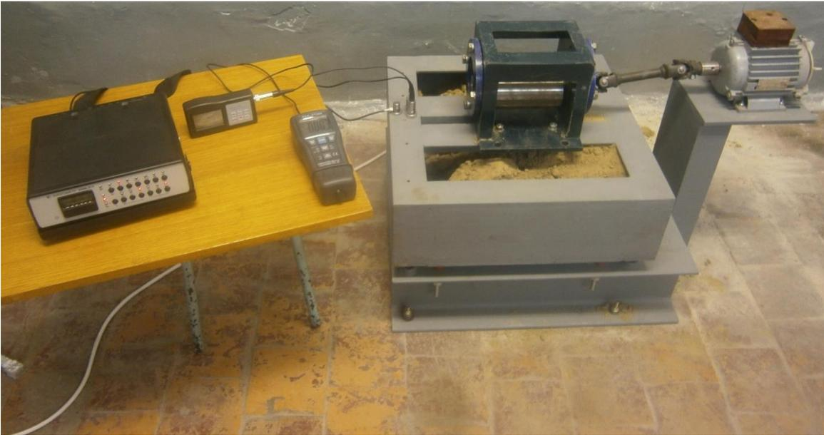
Рис. 1. Лабораторный одновальный вибратор направленных колебаний.
