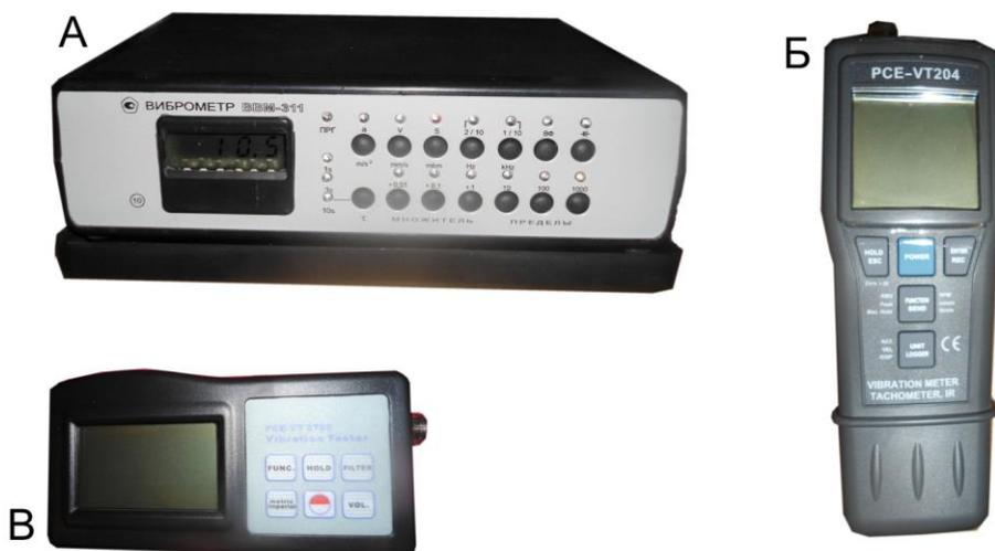
Рис. 2. Виброметры для измерений параметров колебаний.
