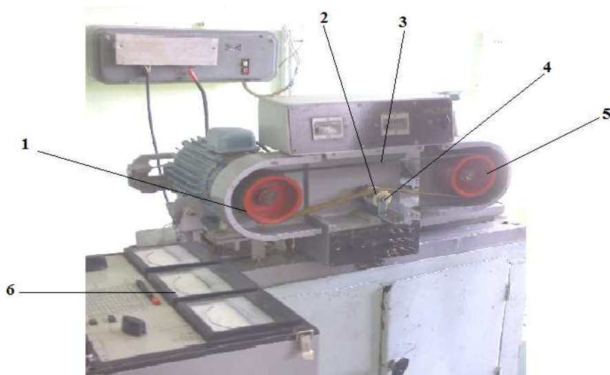
Рис 2. Общий вид модернизированной лабораторной установки ДМ–35У с прибором К–550 для измерения электрических параметров.
