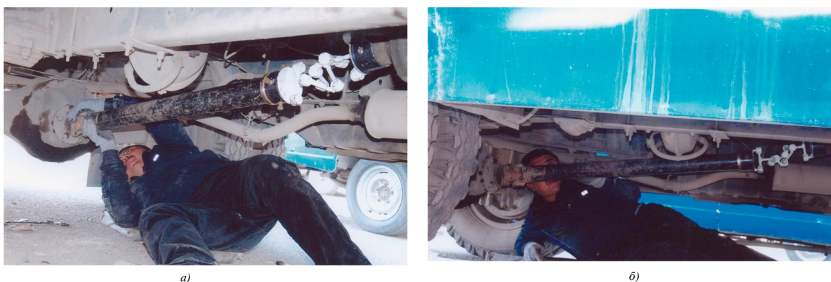
Рис. 2. Общий вид карданного механизма с рычажно-шарнирной муфтой карданного механизма трансмиссии автомобиля КаВЗ-685, где а–установка и регулировка карданного механизма; б – момент проверки вращения валов муфты.
