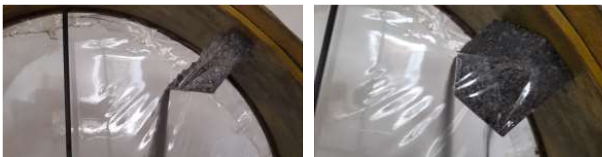
3-расм. Шакл № 1 ва шакл № 4 насадқадан минерал ўғитнинг тўкилиш жараёнлари.
