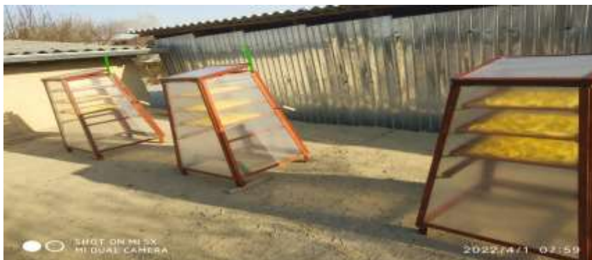
1-расм. Тажрибавий қурилмаларда сабзи махсулотини куриштиш жараёни.
