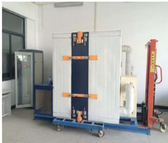
3-расм. Химоя қилувчи иссиқлик қутиси усули ва қурилманинг тасвирлари.
