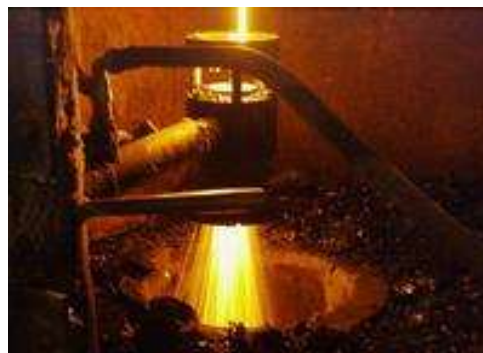
2-расм. Узлуксиз базальт толаларини олиниши.
