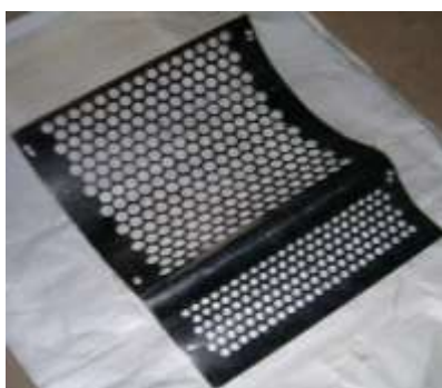
2-расм. Диаметри 16 мм сетканинг чизмасининг кўриниши.
