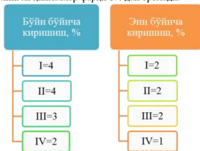
3-расм. Бўйлама йўл-йўл нақшли пахта-ипакли трикотаж тўқима намуналарининг эни ва бўйи бўйича киришиш кўрсаткичлари.
