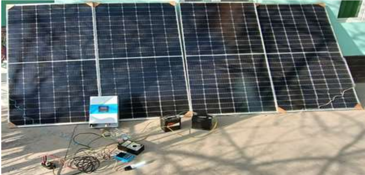
2-расм. Автоном қуёш электр станцияси ва унинг таркибий қисмлари: 500 Втли фото электр батареялар, инвертор 5 кВт, аккумулятор 12 В, тестер, осциллограф.
